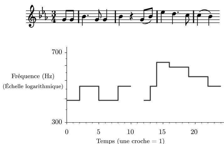
FIG. 4.7: Comparaison entre une ligne de musique, et le tracé de la fréquence du signal correspondant au cours du temps
