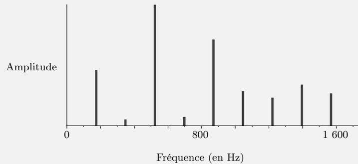
FIG. 4.2: *Spectre simplifié d'une clarinette jouant un fa. L'amplitude des fréquences correspond aux valeurs des coefficients  $b_k$  (les  $a_k$  sont nuls).*
